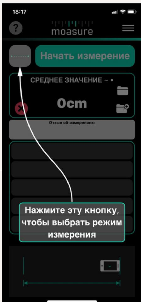
MOASURE - ЭТО ПРИЛОЖЕНИЕ, ИСПОЛЬЗУЮЩЕЕ ДАТЧИКИ ОТСЛЕЖИВАНИЯ ВАШЕГО СМАРТФОНА ДЛЯ ИЗМЕРЕНИЯ РАССТОЯНИЯ. ТОЧНОСТЬ ИХ НЕ СЛИШКОМ ВЫСОКАЯ. НО ЕСЛИ ВЫ ОТКАЛИБРУЕТЕ УСТРОЙСТВО И НЕ БУДЕТЕ ТРАТИТЬ БОЛЕЕ 3 СЕКУНД НА ИЗМЕРЕНИЕ ОДНОГО ОТРЕЗКА, ТО ТОЧНОСТЬ ИЗМЕРЕНИЯ БУДЕТ В ПРЕДЕЛАХ ПОГРЕШНОСТИ ИЗМЕРЕНИЯ РУЛЕТКОЙ.
